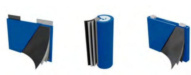
Figura 9. Tipuri tipice de celule pentru bateriile litiu-ion. De la stânga la dreapta: celulă pungă, celulă cilindrică și celulă prismatică. Sursa imaginii: Löbberding et al. 2020.
