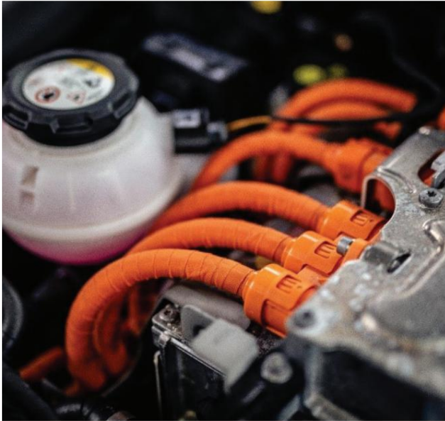
Cablurile cu tensiune înaltă vor fi cel mai adesea de culoare portocalie, ca aici în compartimentul motor
