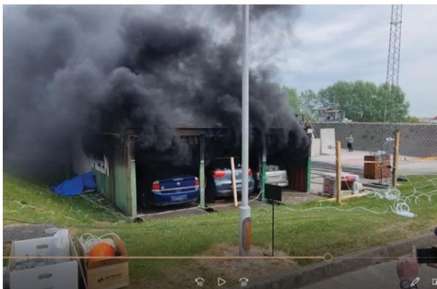
Foto 3: Răspândirea incendiului este acum în mașina electrică și adiacentă mașini.
