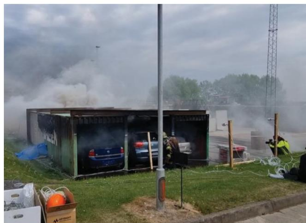
Foto 2: Focul din acumulator crește rapid și focul s-a extins la cabină.
