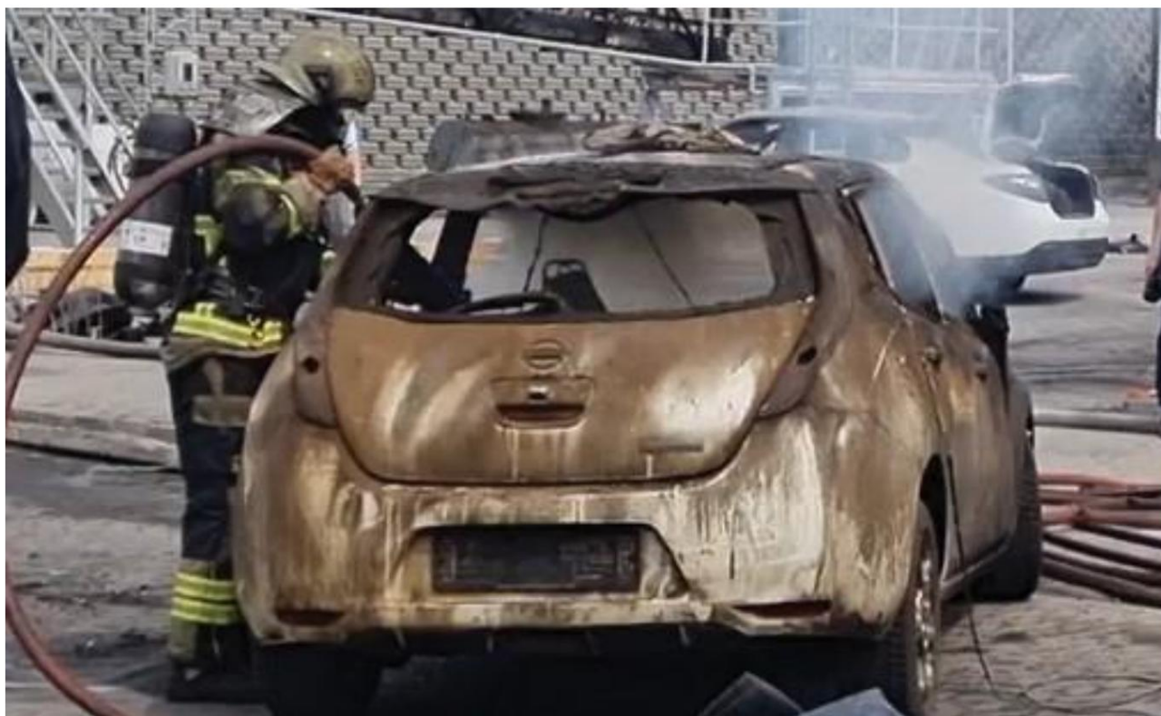
Răcirea bateriei în proiectul ELBAS, 2022 Foto: Agenția daneză de gestionare a situațiilor de urgență
