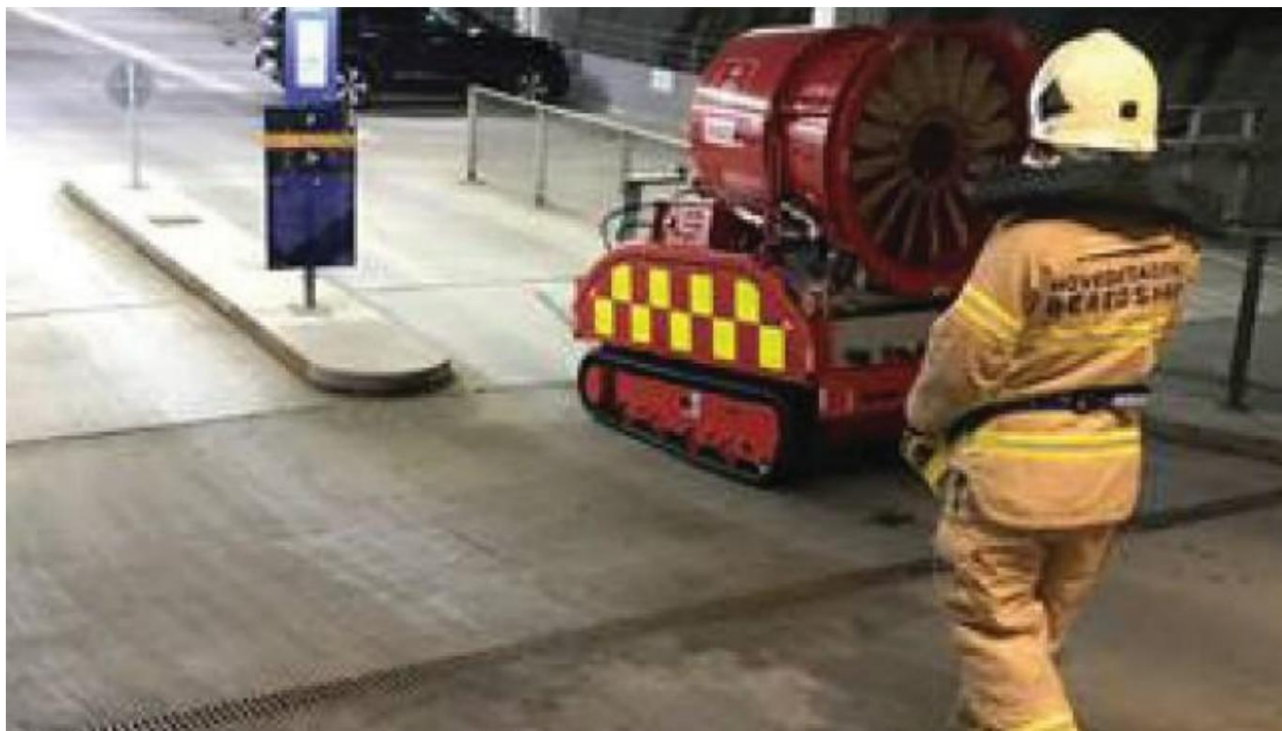
Utilizarea LUF 60, pentru ventilarea și remorcarea unui vehicul electric din parcări subterane sau garaje Foto: Hovedstadens Beredskab
