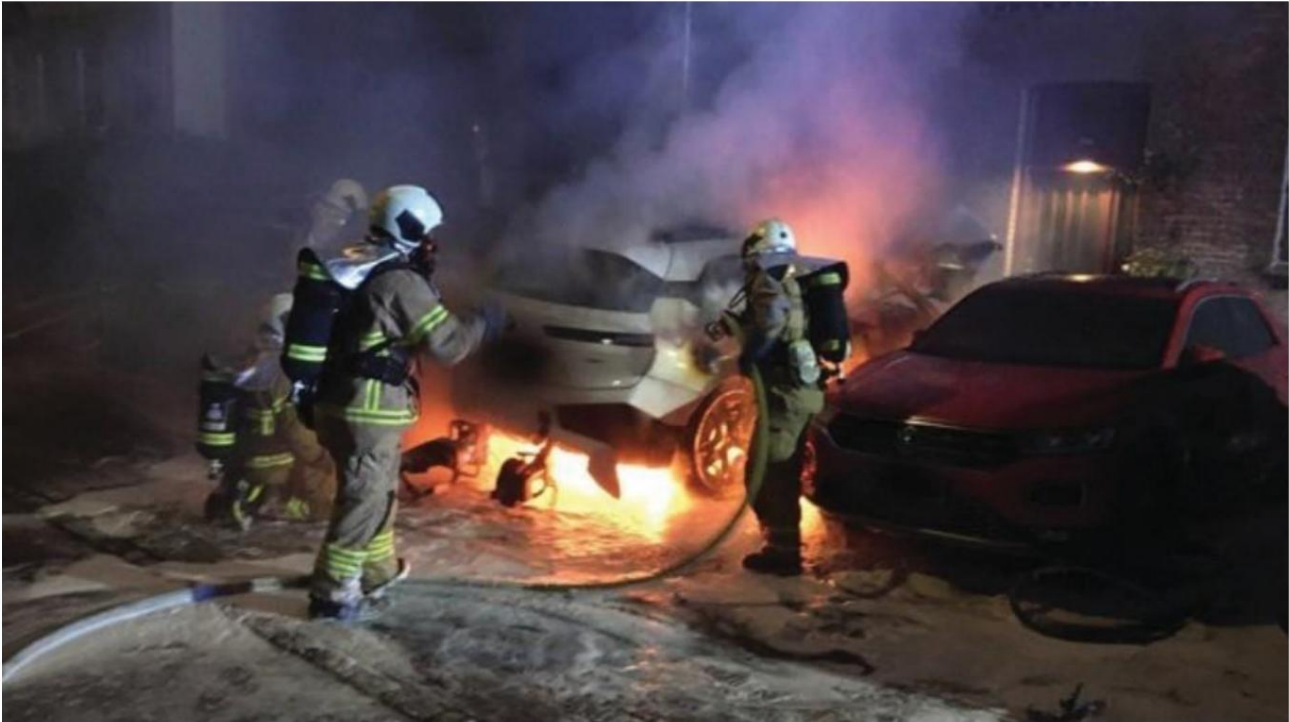
Metoda de ridicare a mașinii electrice pentru o răcire mai directă a acumulatorului din partea de jos a mașinii Foto: Hovedstadens Beredskab
