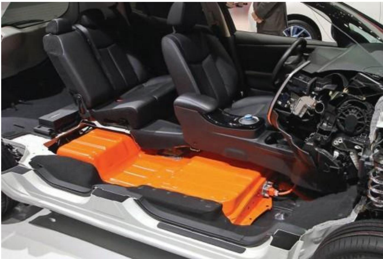
Cadru baterie integrat sub scaune în cabină. Foto: Toyota
