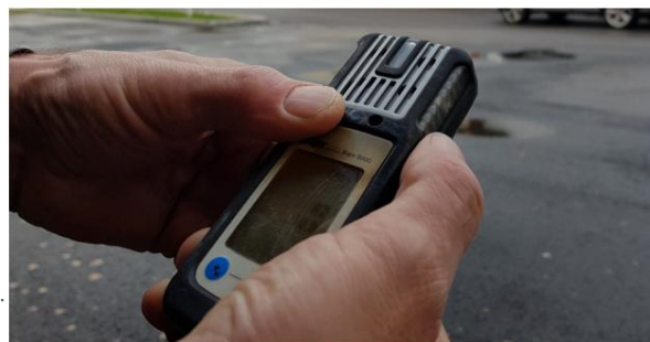
Instrument de măsurare a gazelor. Imagine: Drammen Regional Fire Serviciul IKS.
