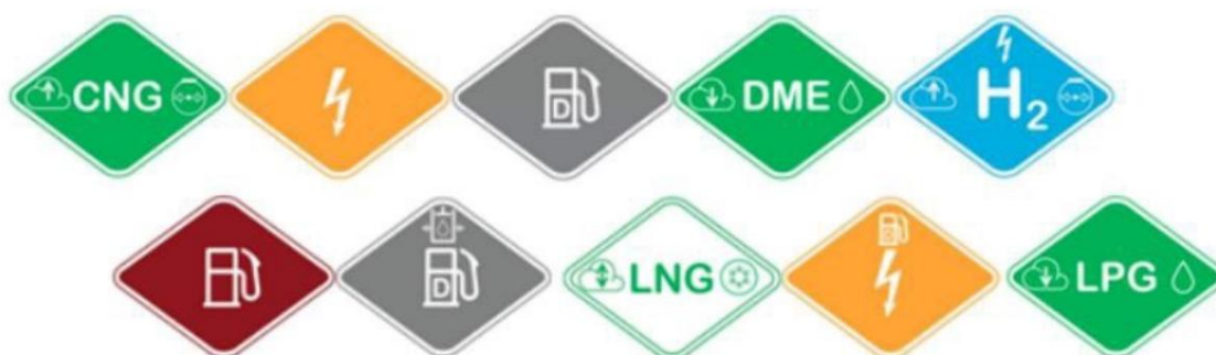
Figura 6. Sistemul european de marcare – surse alternative de energie în vehicule. Sursa CTIF.
