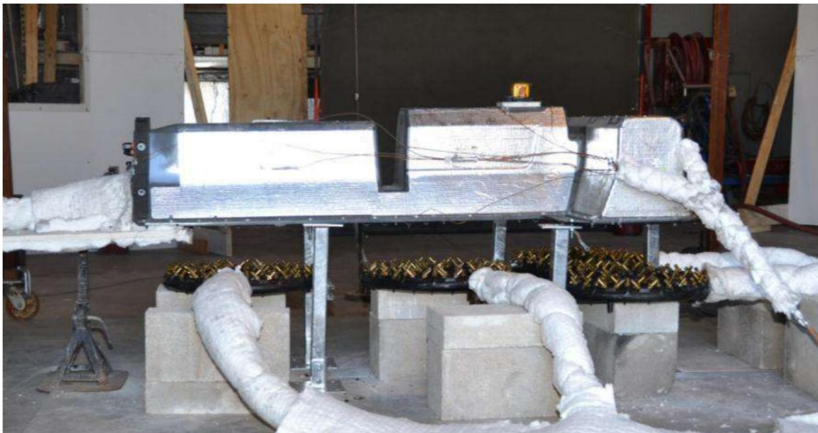
Figura 11 Configurația bateriei B și locațiile arzătorului pentru testarea HRR
