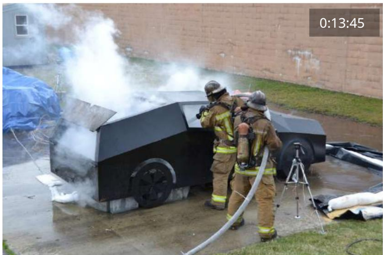
Figura 58 Testul A1: Începe suprimarea (stânga sus); reaprindere și suprimare (dreapta sus, stânga jos); suprimare post (dreapta jos)
