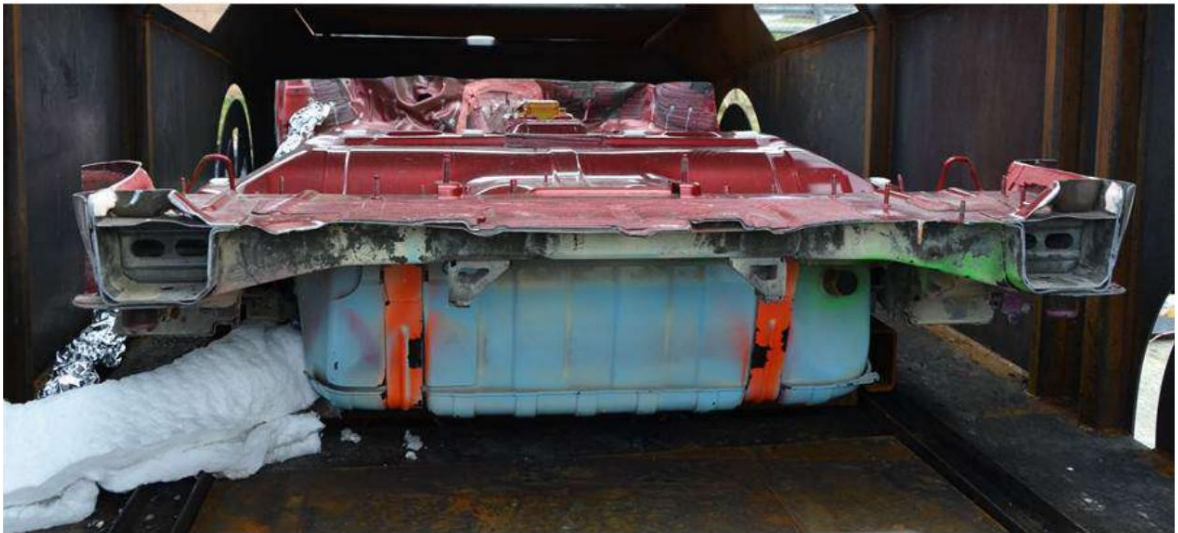
Figura 34 Vedere a bateriei B în interiorul VFT fără panoul de podea (sus) și cu panoul de podea (jos); rezervorul albastru din spatele bateriei este rezervorul de benzină gol pentru vehiculul de producție, care blochează accesul direct în partea din spate a bateriei
