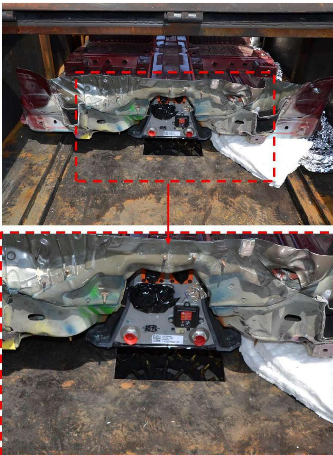
Figura 46 Puncte de conectare la bateria B odată instalată în interiorul VFT (înainte de protecție)
