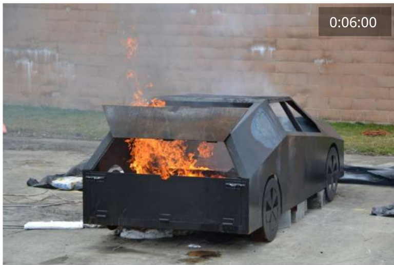
Figura 74 Testul B1: aprindere (stânga sus); degajare de gaze (dreapta sus); implicat pe deplin (stânga jos); arzatoare oprite (dreapta jos)
