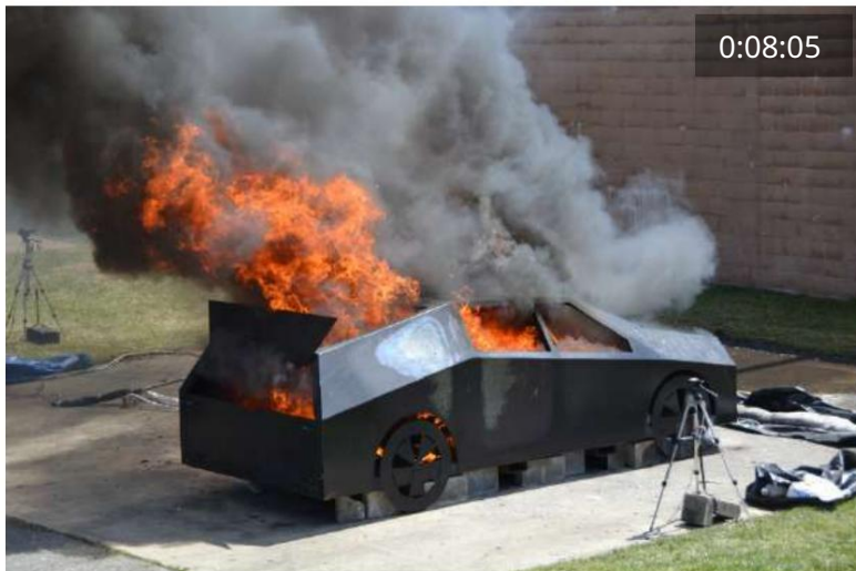
Figura 88 Test B3: aprindere (stânga sus); degajare de gaze (dreapta sus); implicat pe deplin (stânga jos); arzatoare oprite (dreapta jos)
