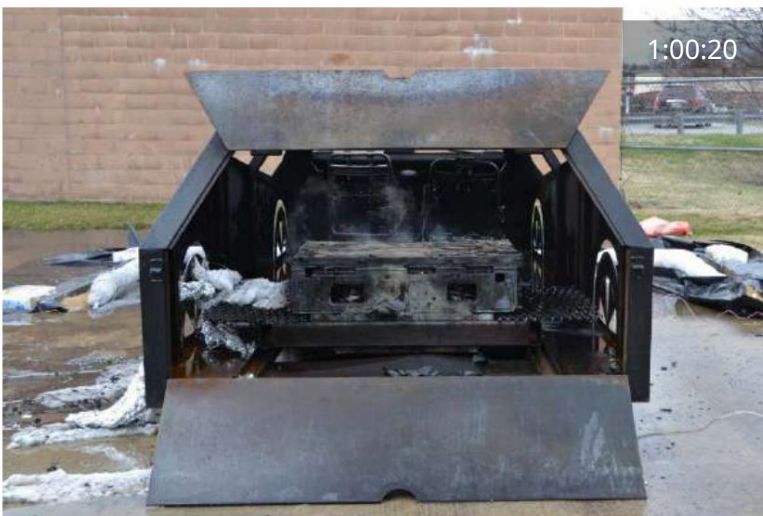
Figura 68 Testul A3: Începe suprimarea (stânga sus); reaprindere și suprimare (dreapta sus, stânga jos); suprimare post (dreapta jos)
