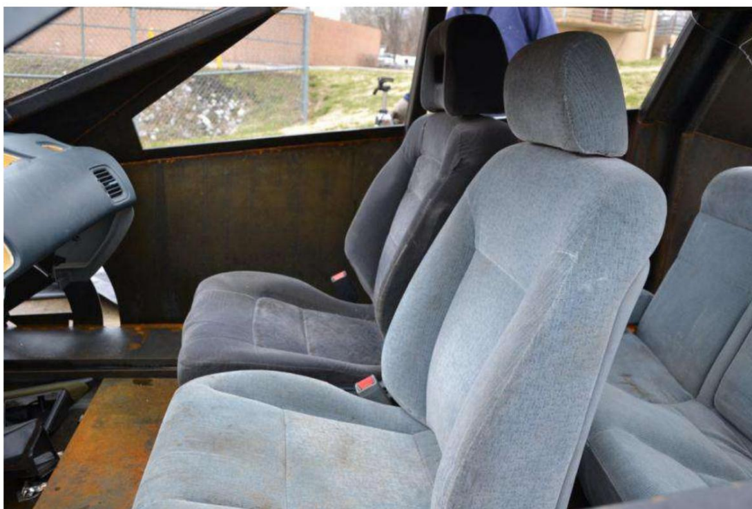
Figura 30 Tabloul de bord și scaunele din față instalate în interiorul VFT pentru testul A3
