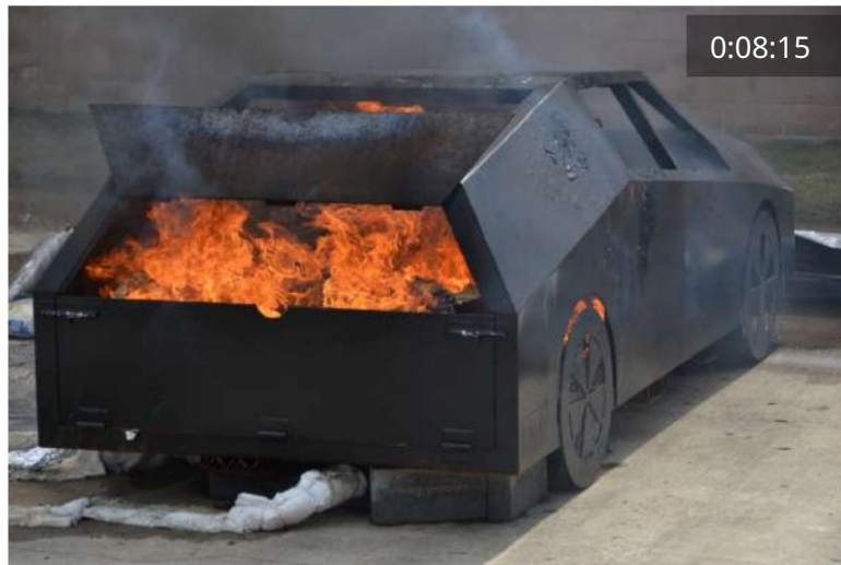
Figura 67 Test A3: aprindere (stânga sus); spate implicat (dreapta sus); implicat pe deplin (stânga jos); arzatoare oprite (dreapta jos)
