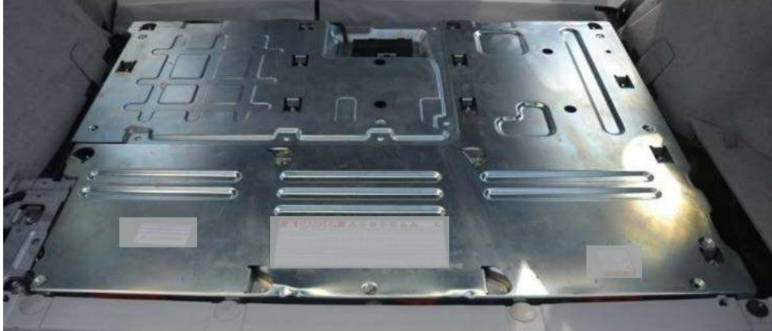
Figura 8 Compartimentul bateriei A din zona de încărcare cu coverul și capacul din plastic turnat scoase
