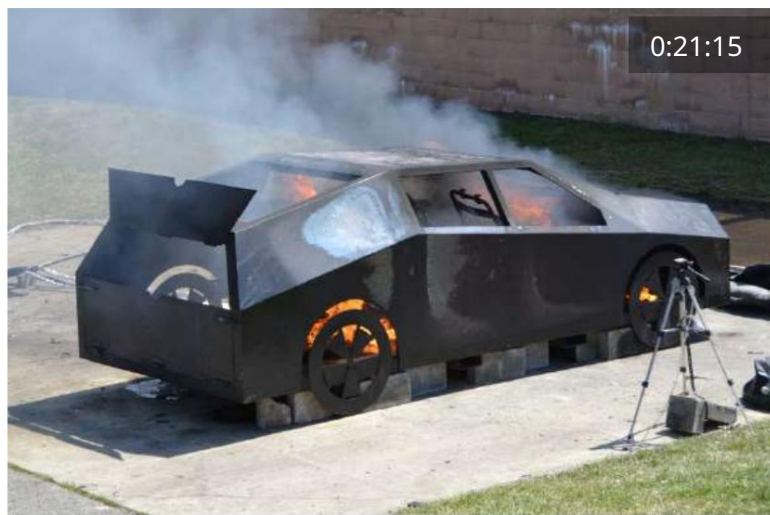
Figura 88 Test B3: aprindere (stânga sus); degajare de gaze (dreapta sus); implicat pe deplin (stânga jos); arzatoare oprite (dreapta jos)
