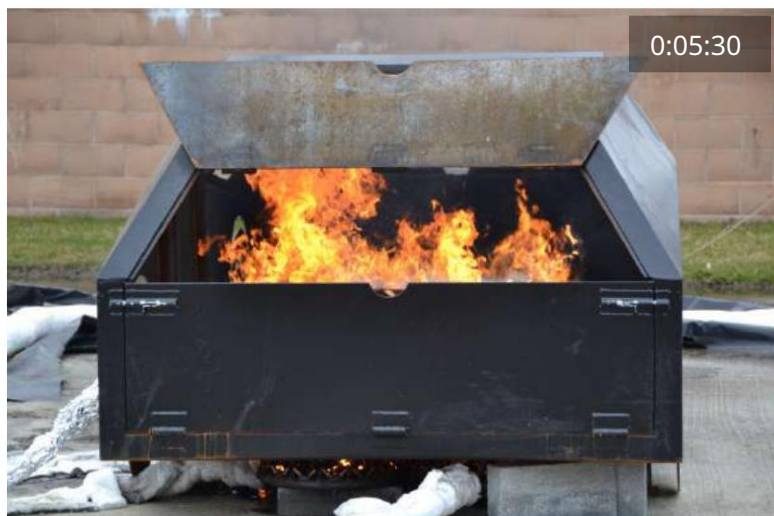
Figura 62 Testul A2: aprindere (stânga sus); degajare de gaze (dreapta sus); implicat pe deplin (stânga jos); arzatoare oprite (dreapta jos)
