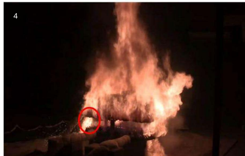
Figura 51 14:50 minute: Un flux mare de scântei iese din partea de jos a capătului NV al bateriei din interiorul acesteia
