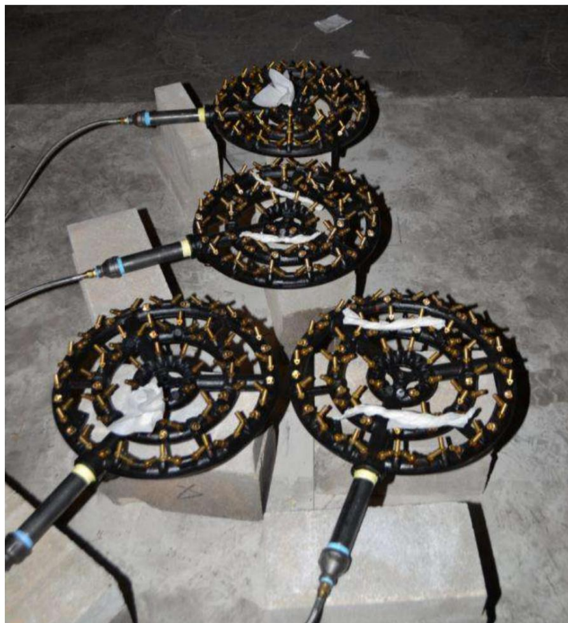
Figura 15 Arzător în formă de T compus din patru arzătoare
