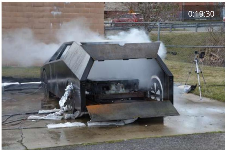
Figura 58 Testul A1: Începe suprimarea (stânga sus); reaprindere și suprimare (dreapta sus, stânga jos); suprimare post (dreapta jos)
