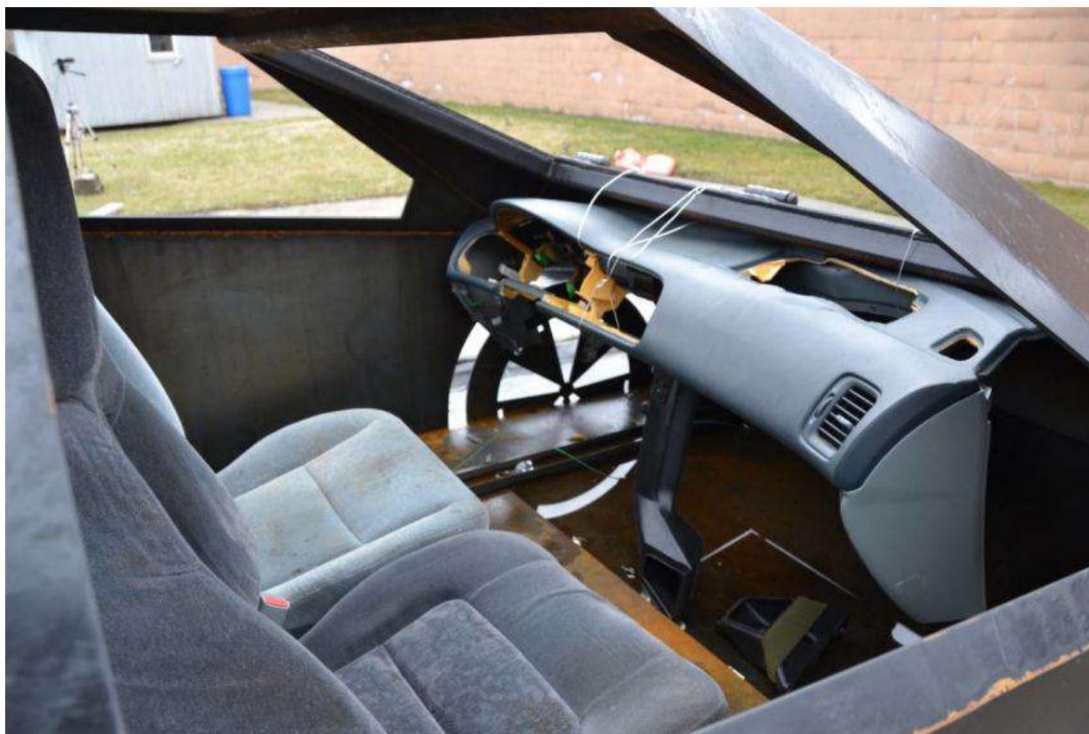
Figura 30 Tabloul de bord și scaunele din față instalate în interiorul VFT pentru testul A3
