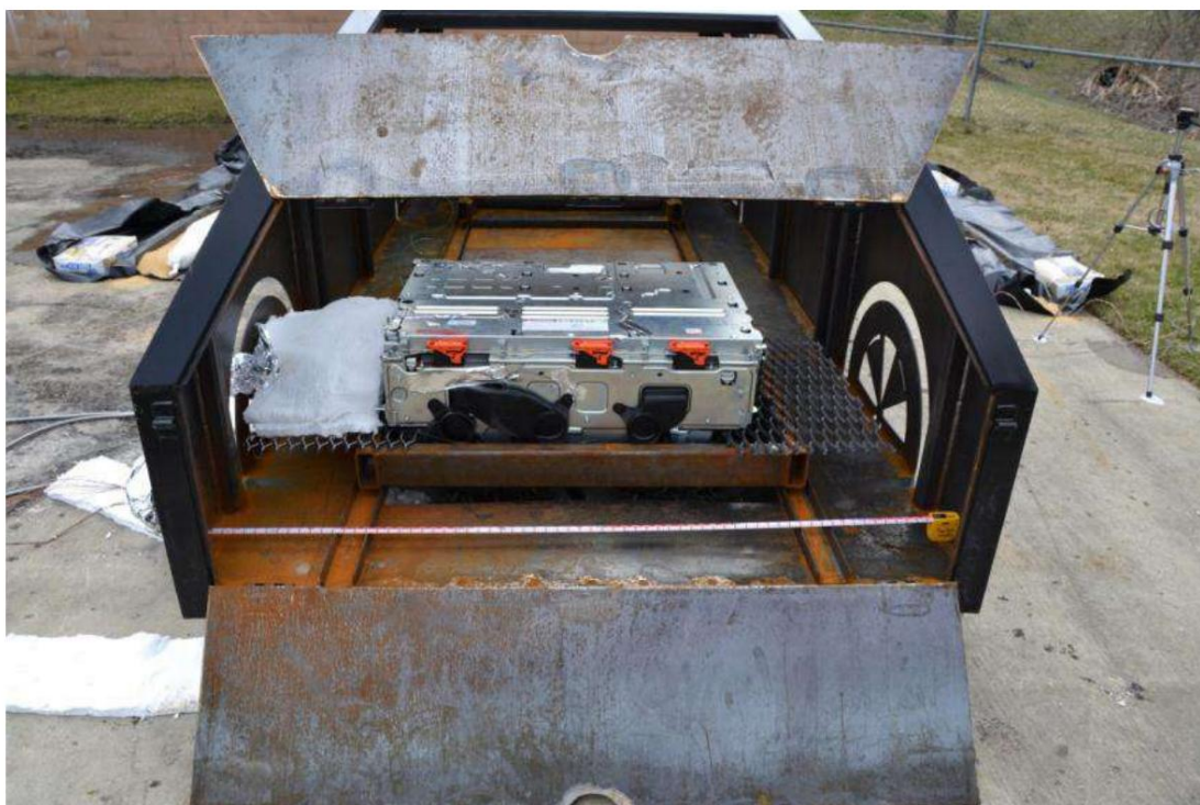
Figura 25 Căruțor instalat în interiorul VFT poziționat deasupra celor patru arzătoare situate în poziția de testare din spate
