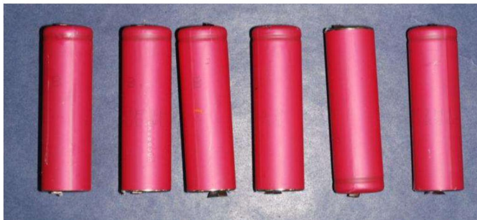
Figura 3 Exemplu de 18650 de celule cilindrice (acestea sunt cele mai comune electronice de larg consum factor de formă a celulei Li-ion)
