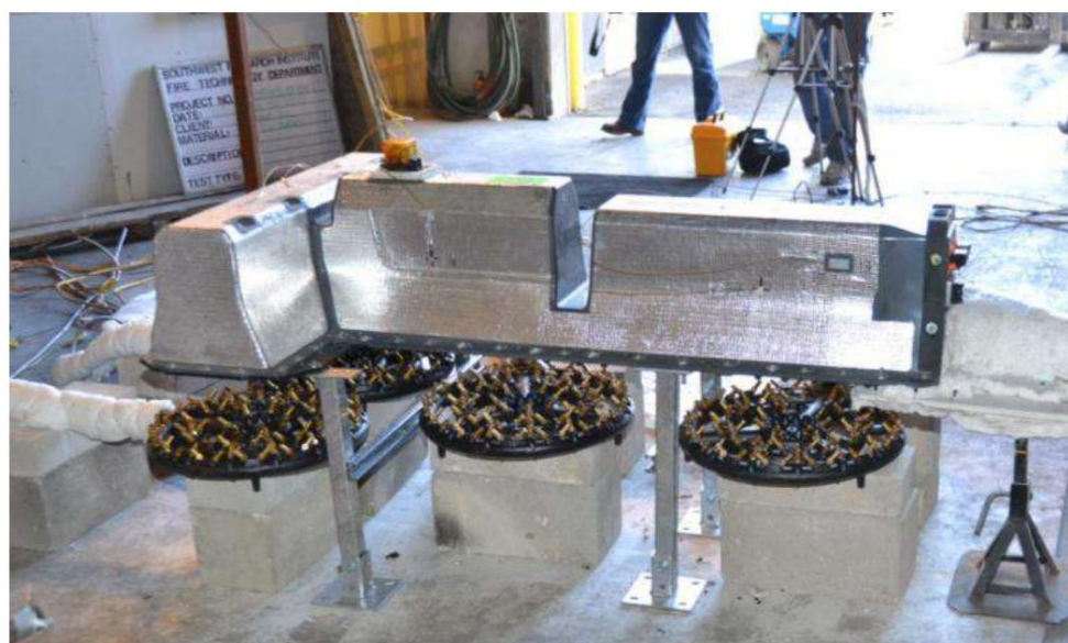
Figura 15 Arzător în formă de T compus din patru arzătoare
