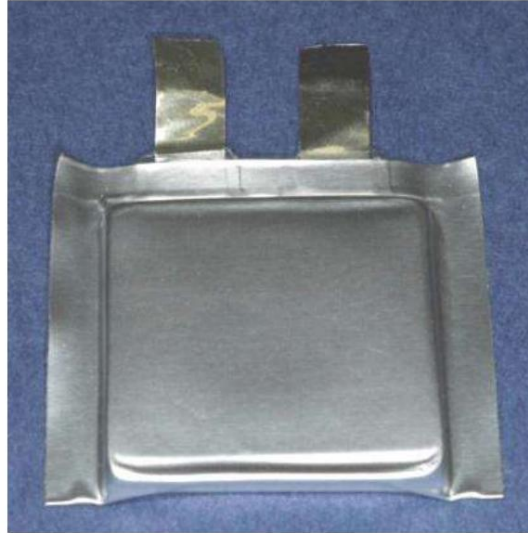
Figura 5 Exemplu de celulă polimerică cu pungă moale
