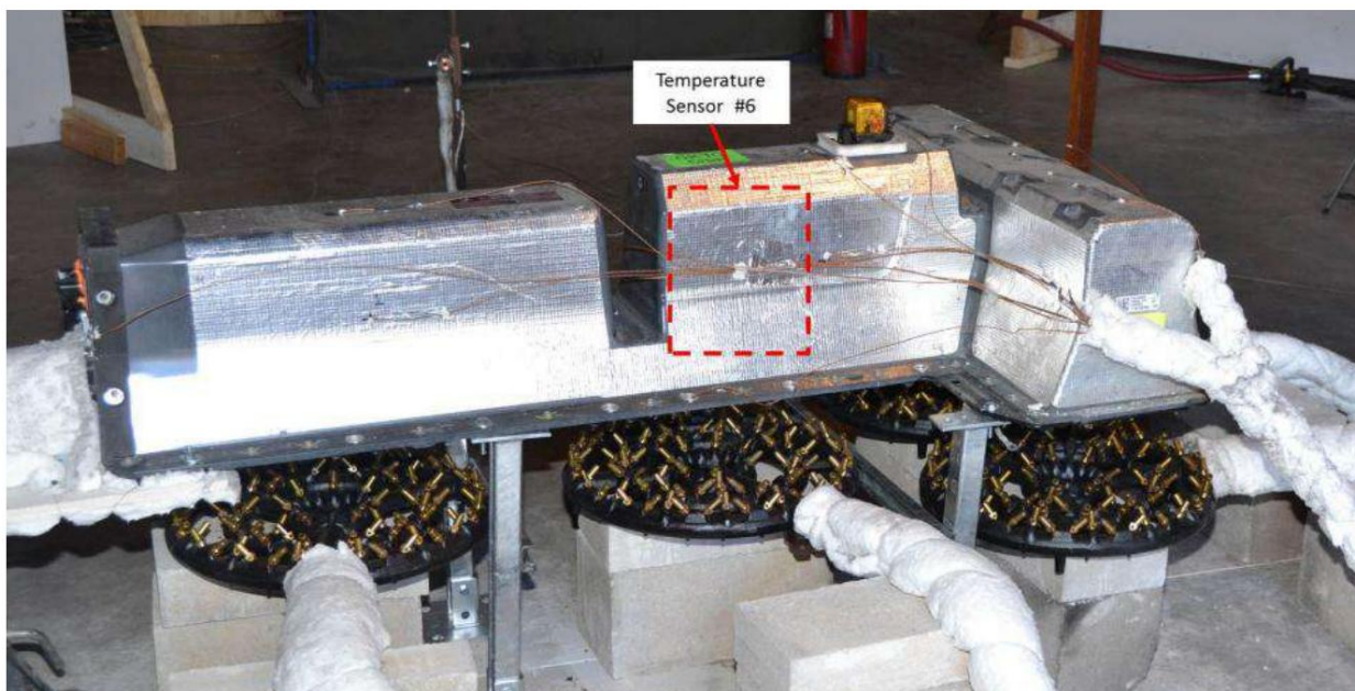
Figura 85 Locația senzorului de temperatură nr. 6 în baterie B2
