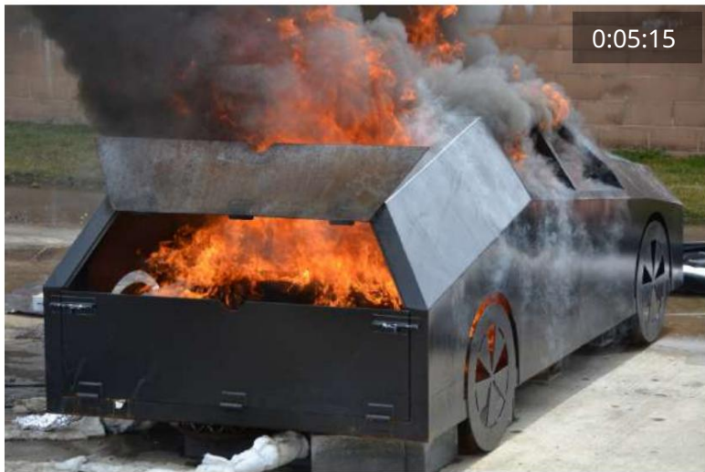
Figura 67 Test A3: aprindere (stânga sus); spate implicat (dreapta sus); implicat pe deplin (stânga jos); arzatoare oprite (dreapta jos)
