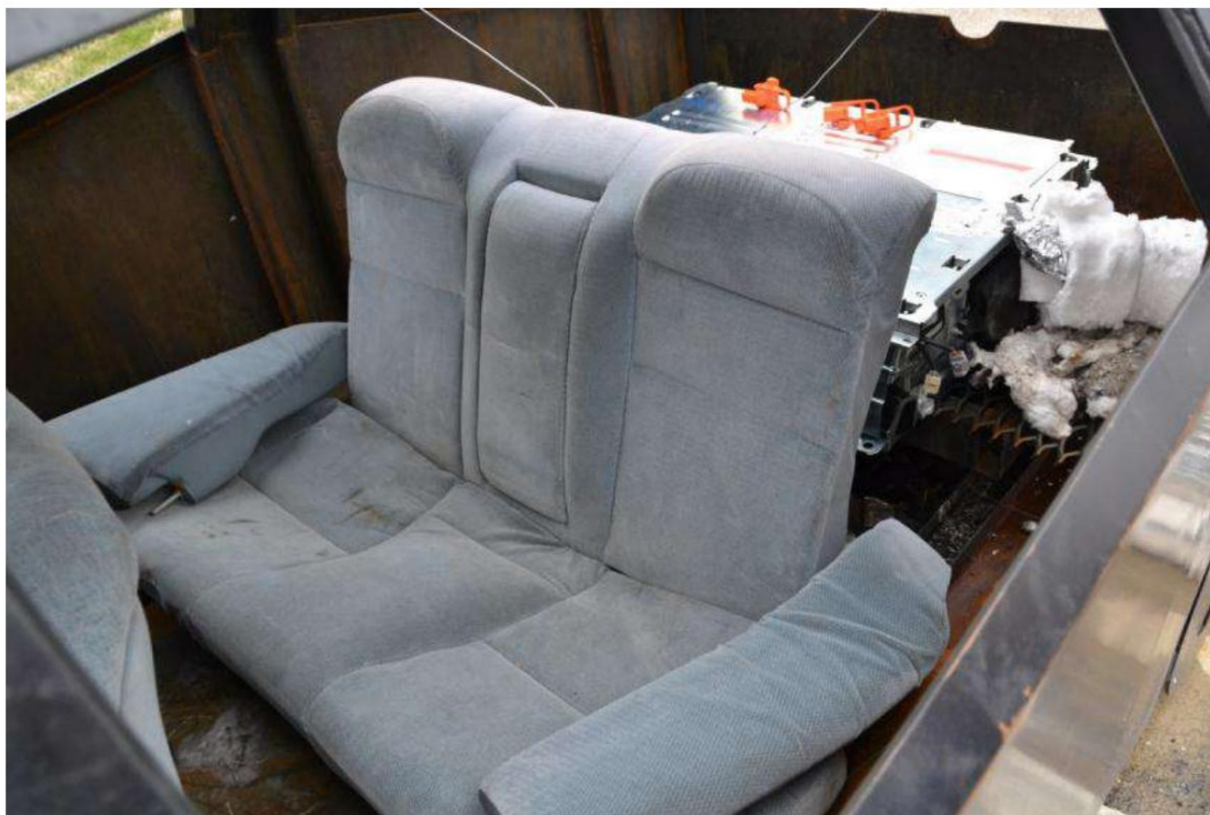
Figura 32 Scaunele din spate instalate în interiorul VFT pentru Testul A3
