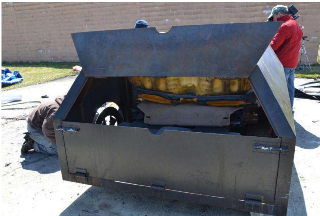
Figura 40 Scaunele din spate și covorul instalate în interiorul VFT pentru Testul B3
