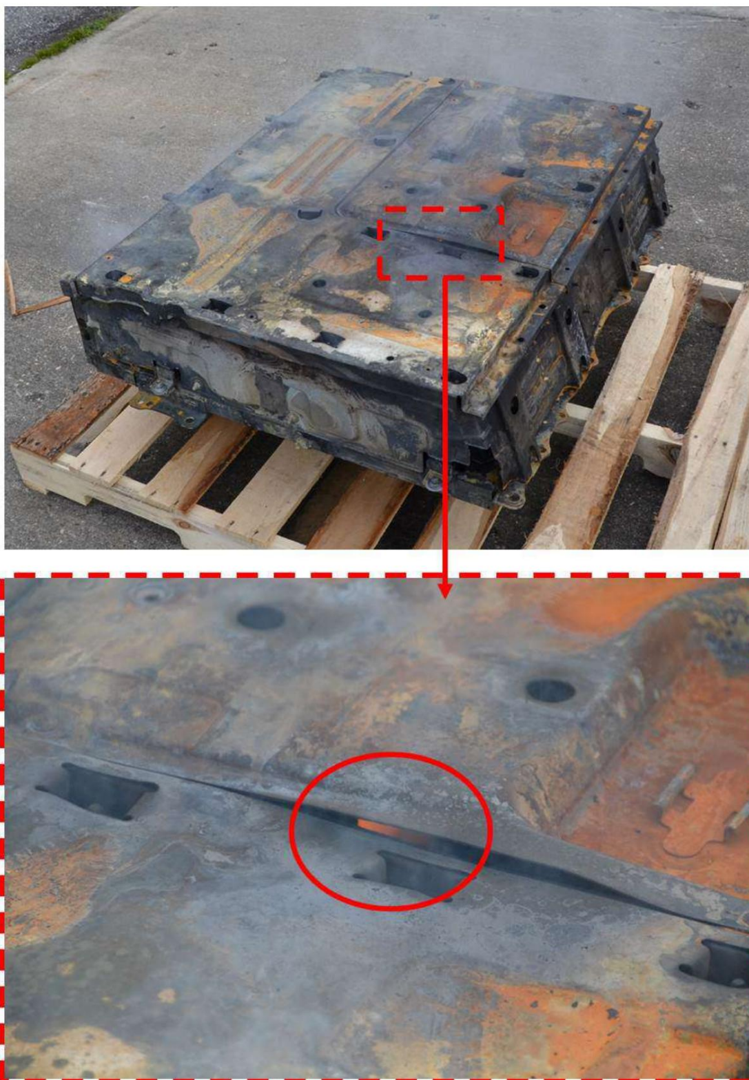
Figura 73 Reapriinderea bateriei A3 la aproximativ 22 de ore după încheierea testului (flacara incercuita rosu)
