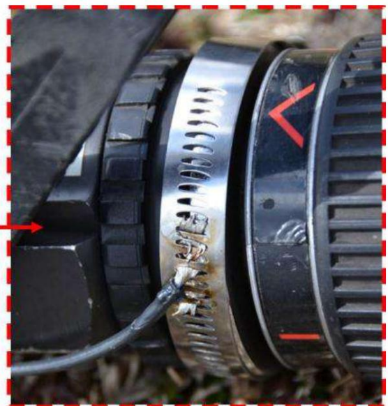
Figura 41 Sârmă de cupru torsionată de 14 AWG lipită la o clemă de furtun și fixată pe carcasa exterioră a duzei
