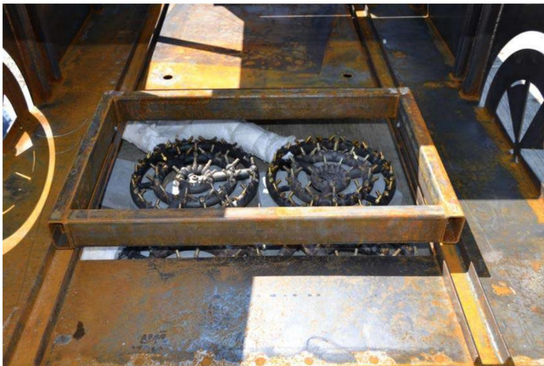
Figura 25 Căruțor instalat în interiorul VFT poziționat deasupra celor patru arzătoare situate în poziția de testare din spate
