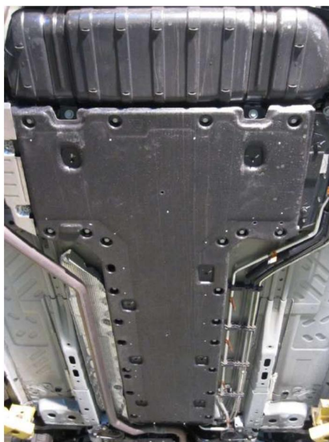
Figura 10 Bateria B instalată în vehicul
