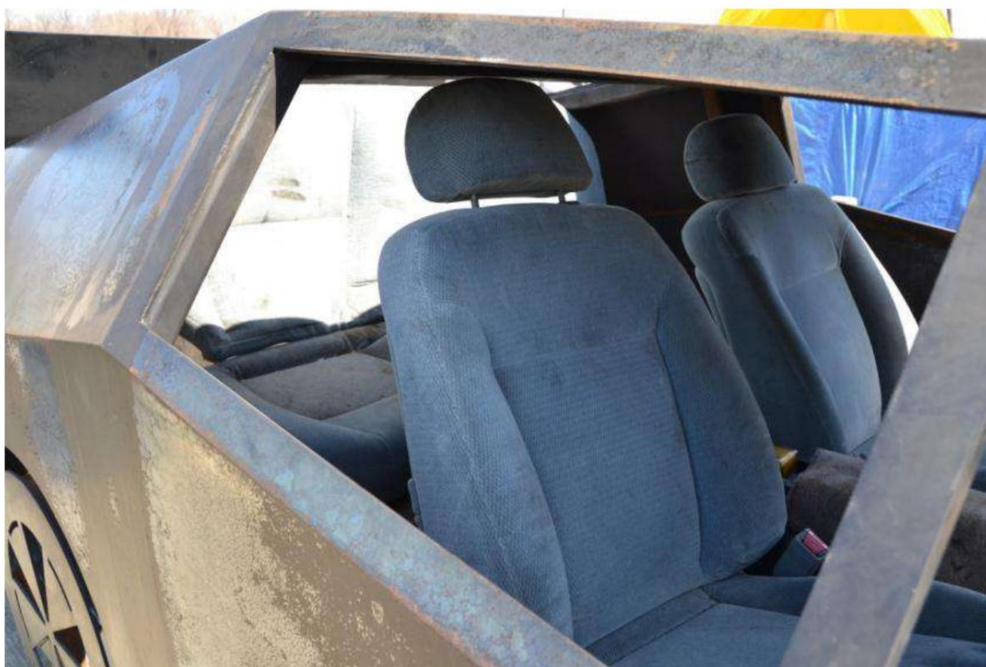
Figura 38 Scaune din față și cover instalate în interiorul VFT pentru Testul B3
