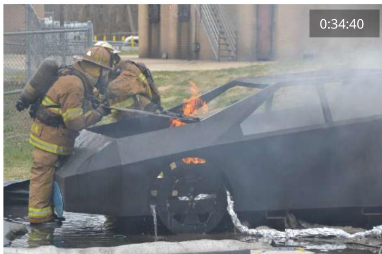
Figura 75 Testul B1: începe suprimarea (stânga sus); reaprindere și suprimare (dreapta sus, stânga jos); suprimare post (dreapta jos)
