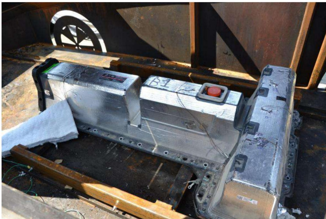
Figura 27 Bateria B poziționată pe cărucior deasupra arzătoarelor din interiorul VFT; arzătoare situate în poziția centrală de testare
