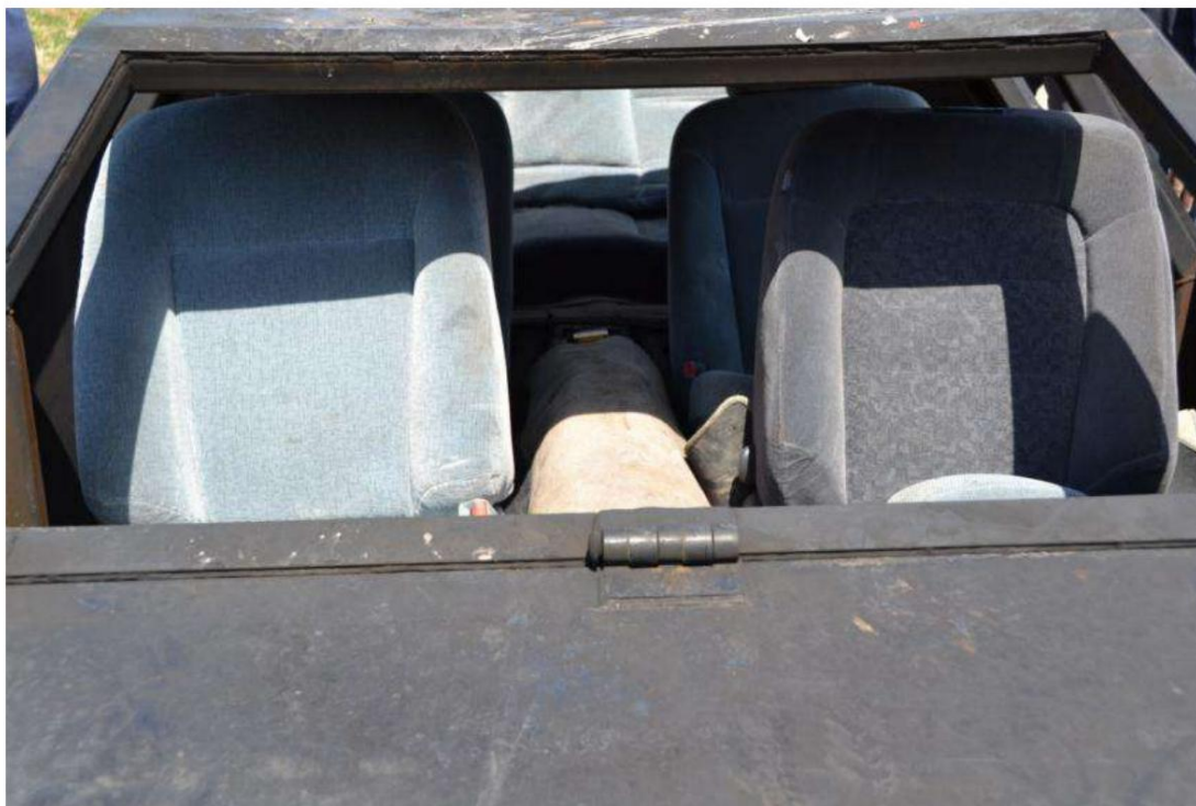
Figura 38 Scaune din față și cover instalate în interiorul VFT pentru Testul B3
