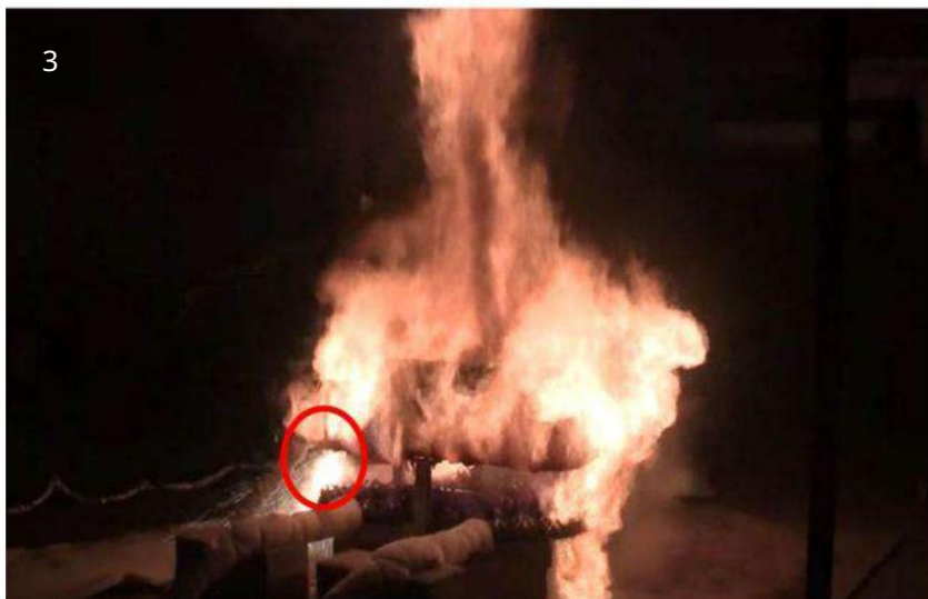
Figura 51 14:50 minute: Un flux mare de scântei iese din partea de jos a capătului NV al bateriei din interiorul acesteia
