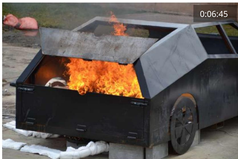
Figura 57 Test A1: aprindere (stânga sus); degajare de gaze (dreapta sus); implicat pe deplin (stânga jos); arzatoare oprite (dreapta jos)
