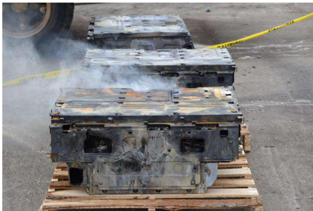
Figura 72 Gazificarea bateriei A3 la aproximativ 22 de ore după încheierea testului
