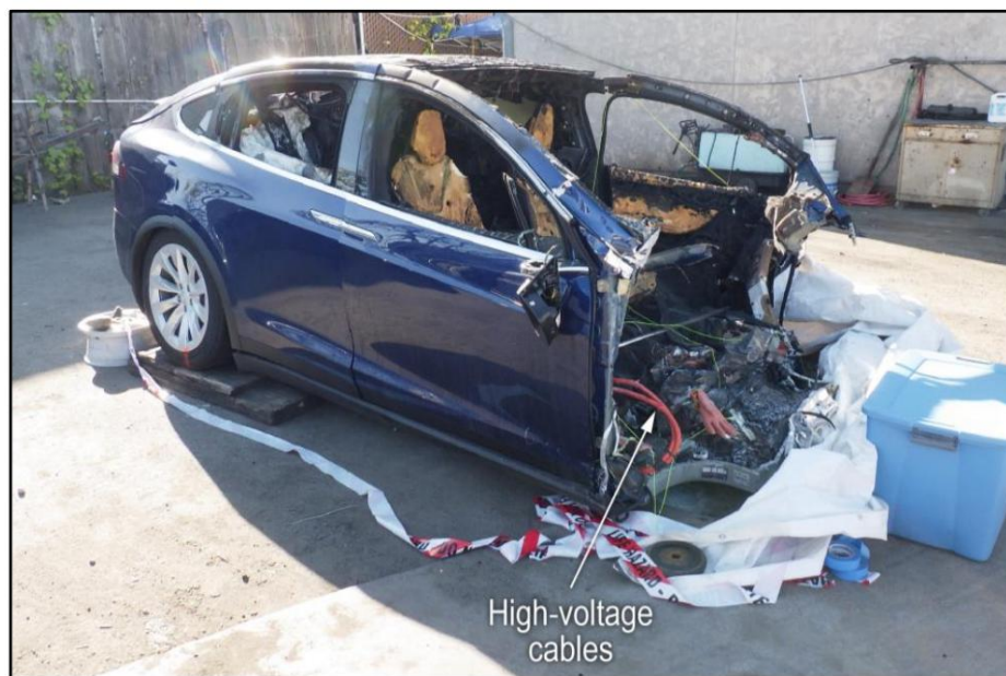
Figura 8. SUV deteriorat cu cabluri portocalii de înaltă tensiune expuse în fața scaunului din față.
