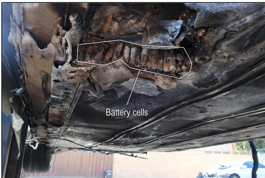
Figura 4. Vedere de jos și spre spate a părții inferioare a SUV-ului, care arată colțul din față drept rupt al carcasei bateriei și evidențiază celulele individuale ale bateriei descoperite de ruptură. Roata din spate dreapta este vizibilă în fundal.
