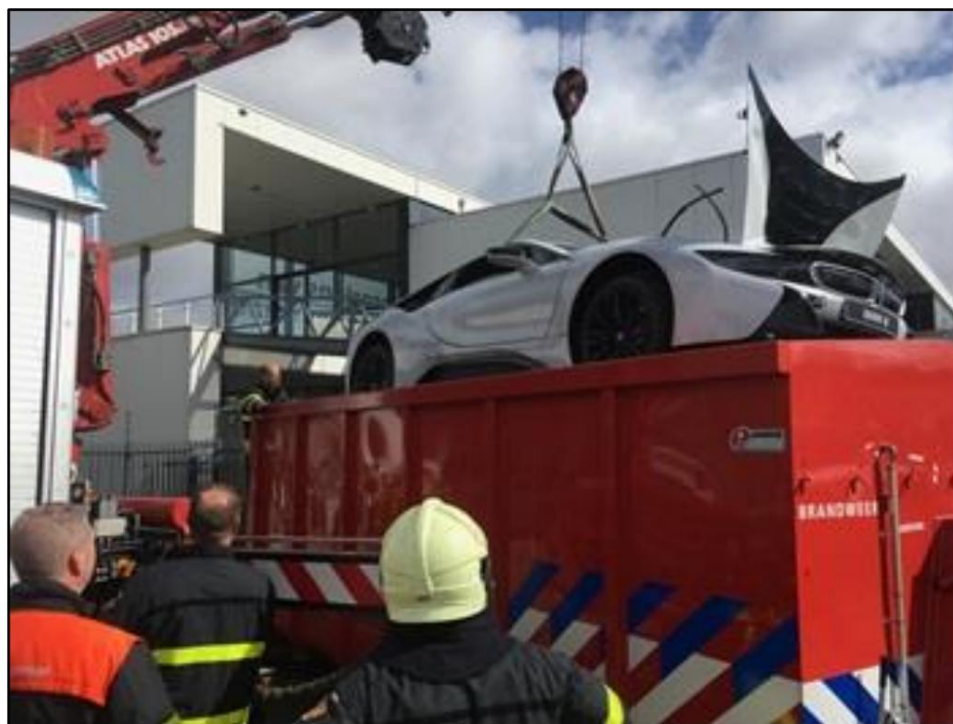
Figura 18. BMW încărcat într-un rezervor umplut cu apă. (Sursa: Brigada de Pompieri din Brabantul Central și de Vest)
