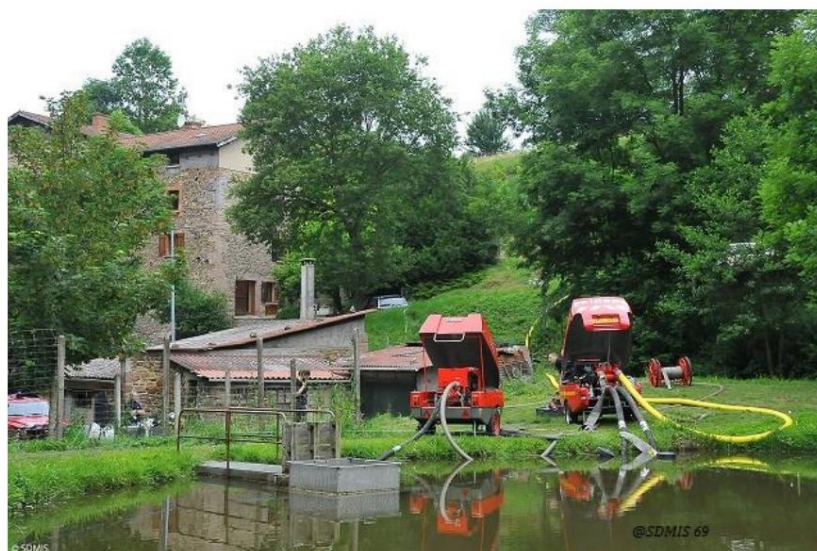
Ilustrația nr. 5: Furnizarea a două linii de 110 de la motopompe (Crédit foto @ SDMIS 69)
