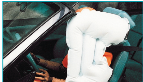
Airbag montat în scaun, pentru impact lateral
