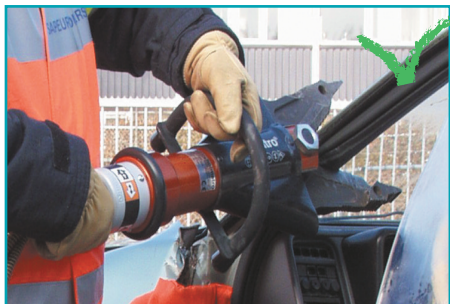
Material poziționat corect, în interiorul fălcilor
