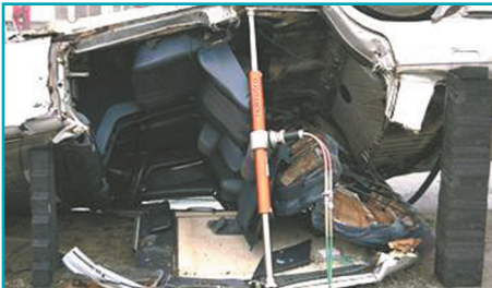
Cilindru hidraulic folosit pentru a crea spațiu
