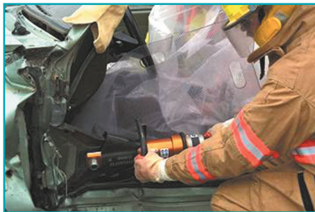
Ridicarea tabloului de bord folosind unealta combinată
