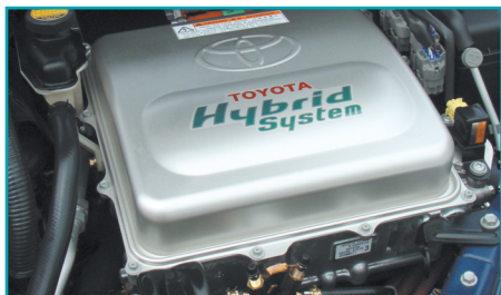
Sistemul electronic de comandă al unui vehicul Toyota “Prius”
