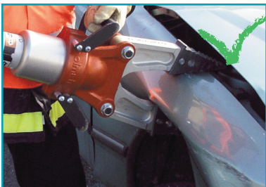
Utilizarea întregii suprafețe a vârfulor de depărtare
