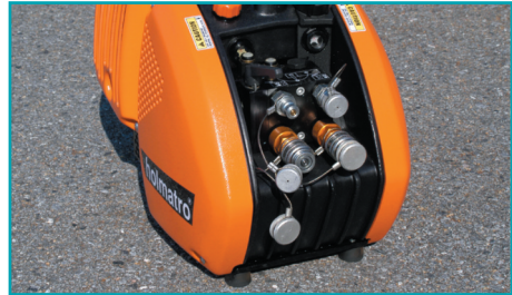
Montarea capacelor de protecție
