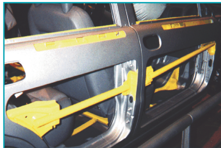
Traversa de ranforsare din ușă, pentru mărirea siguranței la impactul lateral, poate provoca, în cazul unei coliziuni frontale, dificultăți în înlăturarea ușilor
