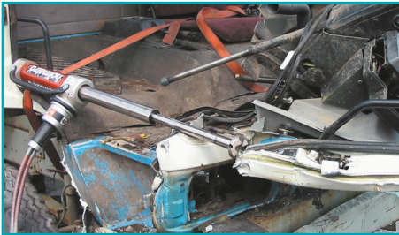
Cilindru hidraulic cu pistoane telescopice deschis la maxim
