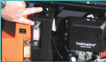
Verificarea nivelului de combustibil
