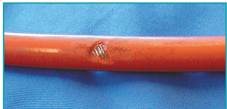
Nu utilizați furtunuri deteriorate
