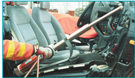
Poziție corectă a manșonului de comandă
