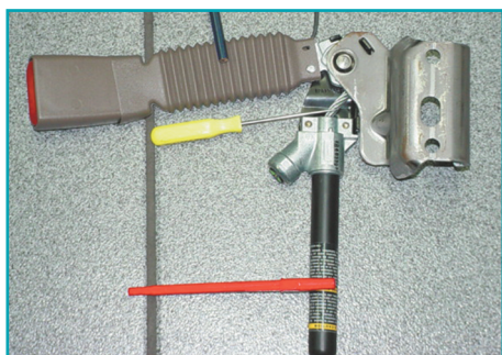
Element de pretensionare a centurii de siguranță
