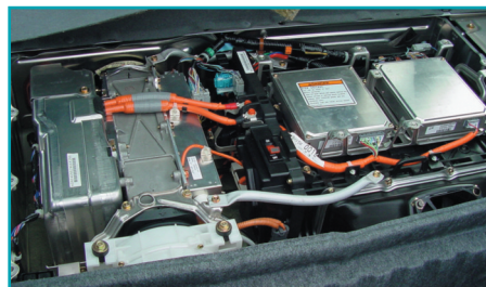
Sistemul de baterii al unui vehicul Honda “Insight”
