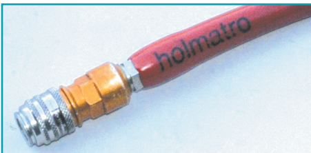
Verificarea manșonului anti-îndoire
