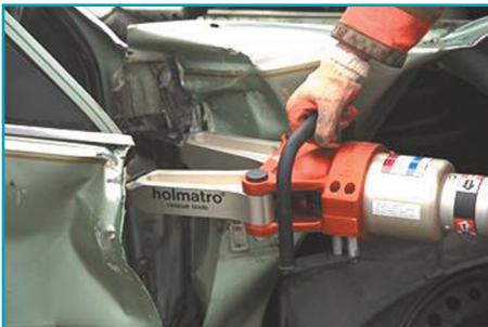
Depărtarea unei uși față de caroseria vehiculului
