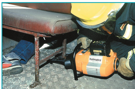
Unealta autonomă de descarcerare, cu care se lucrează bine în spații înguste cum sunt cele din autobuz
