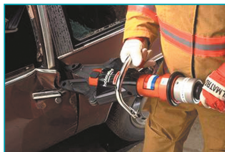
Depărtarea unei uși față de caroseria vehiculului
