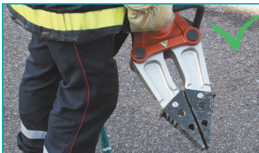
Depărtător transportat corect, ținut de mâner
