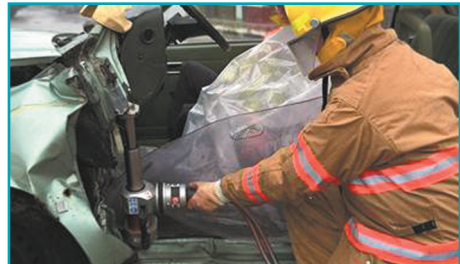
Ridicarea tabloului de bord folosind un cilindru hidraulic
